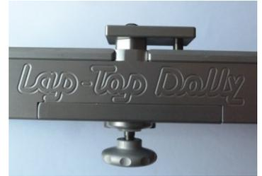
Montierte Schiebestange und Deichselarretierungsklötzchen vor einer Schienenfahrt
