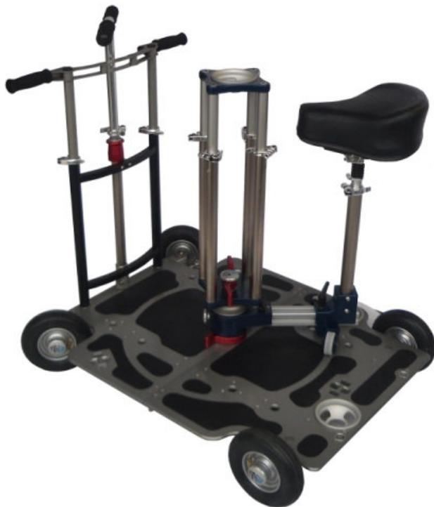
Zuerst wird das Drehkreuz in der Mitte des Dollybodens eingeschraubt. Achten Sie darauf, dass die beiden Rädchen am Ende des Drehkreuzes genau in der dafür vorgesehenen Aussparung einen Kreis fahren können und nicht über Gummi fahren. Sitz mit Sitzverlängerung werden angesetzt und die Bazooka (100mm Schale) über den klassischen Euroadapter verbunden.
