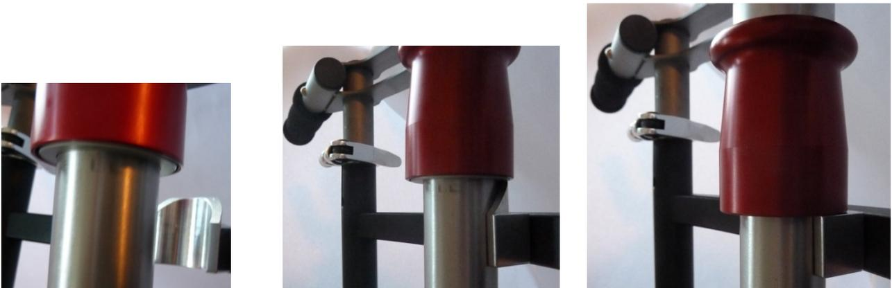
Die bewegliche rote Hülse kann die Lenkstange nur an der Schiebestange sichern, wenn beide Stangen etwas ausgefahren sind. Die Lenkstange muss dabei höher als die Schiebestange ausgefahren sein.
